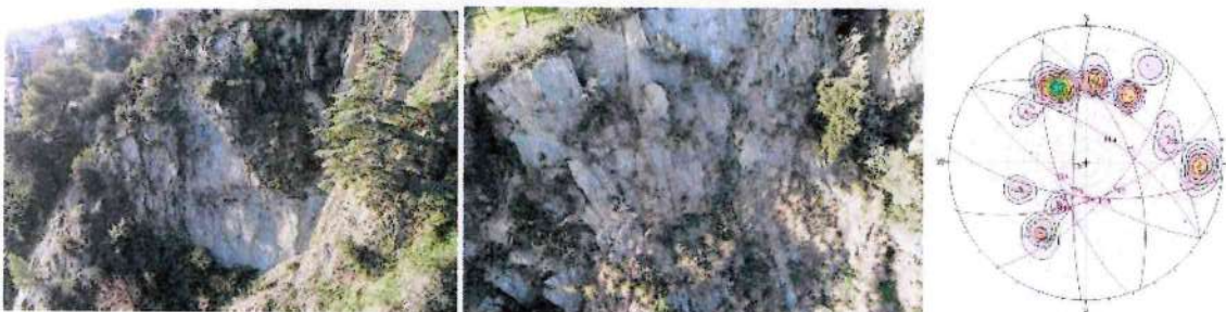
Figura 9 - Affioramenti sul versante B e stereogrammi di Schmidt relativi al versante con rappresentazione dei poli delle giaciture rilevate mediante curve isodensità e sovrapposizione delle principali famiglie di discontinuità
