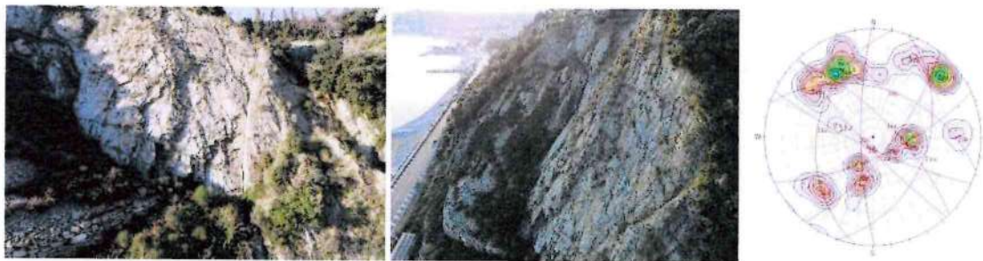
Figura 8 - Affioramenti sul versante A e stereogrammi di Schmidt relativi al versante con rappresentazione dei poli delle giaciture rilevate mediante curve isodensità e sovrapposizione delle principali famiglie di discontinuità
