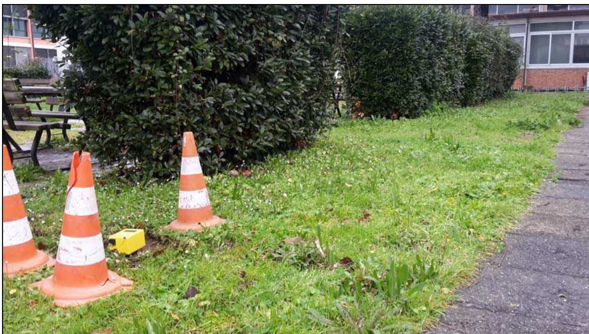
TR1 – Sito di indagine e strumento utilizzato per la registrazione del segnale sismico (Tromino, modello TRZ-0101/01-10)
