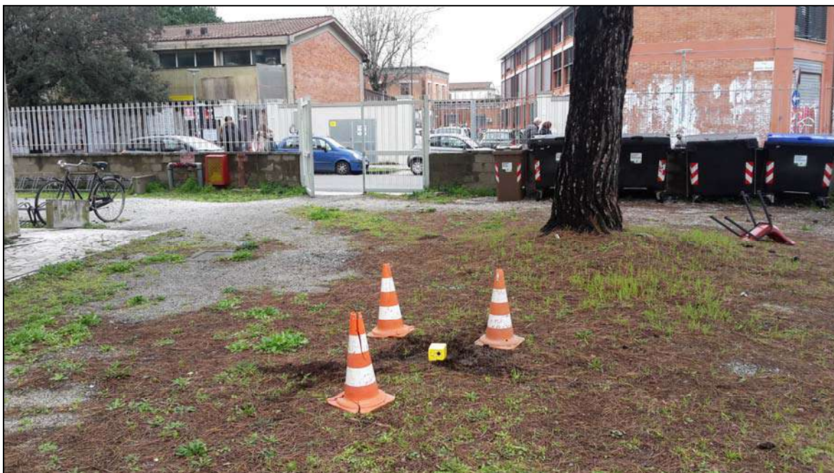
TR2 – Panoramica della seconda misura di microtremore sismico
