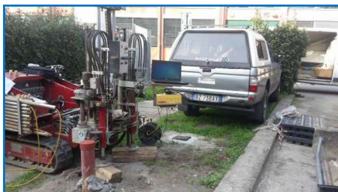
Alcune fasi dell'esecuzione del “cono sismico” SCPTU 3
