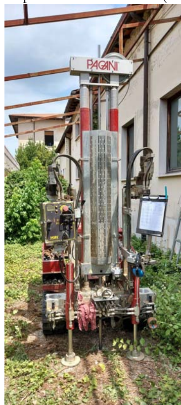
Prova penetrometrica dinamica (DPSH4)
