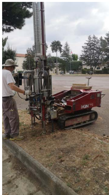
Prova penetrometrica statica (CPT2)
