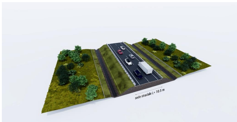
Figura 2 - Sezione tipo strada di categoria "C"
